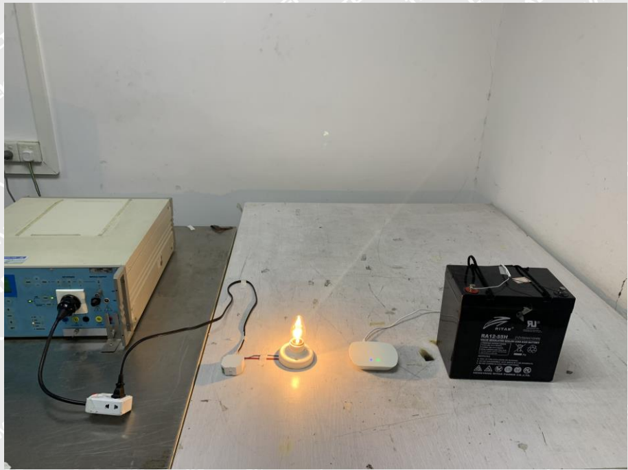
EN 61000-4-4/5/11 Test View
